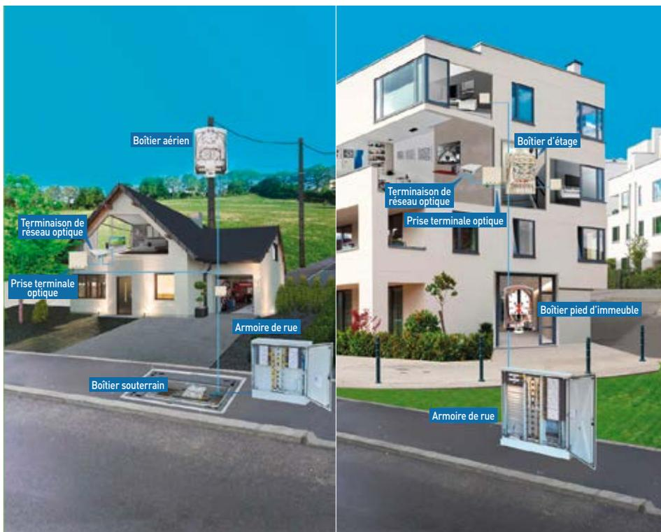
Schémas de raccordement de la fibre optique dans une maison individuelle et dans un immeuble collectif (source : Covage).
