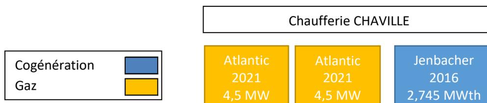
Figure 1 – Schéma des productions du réseau de chaleur
